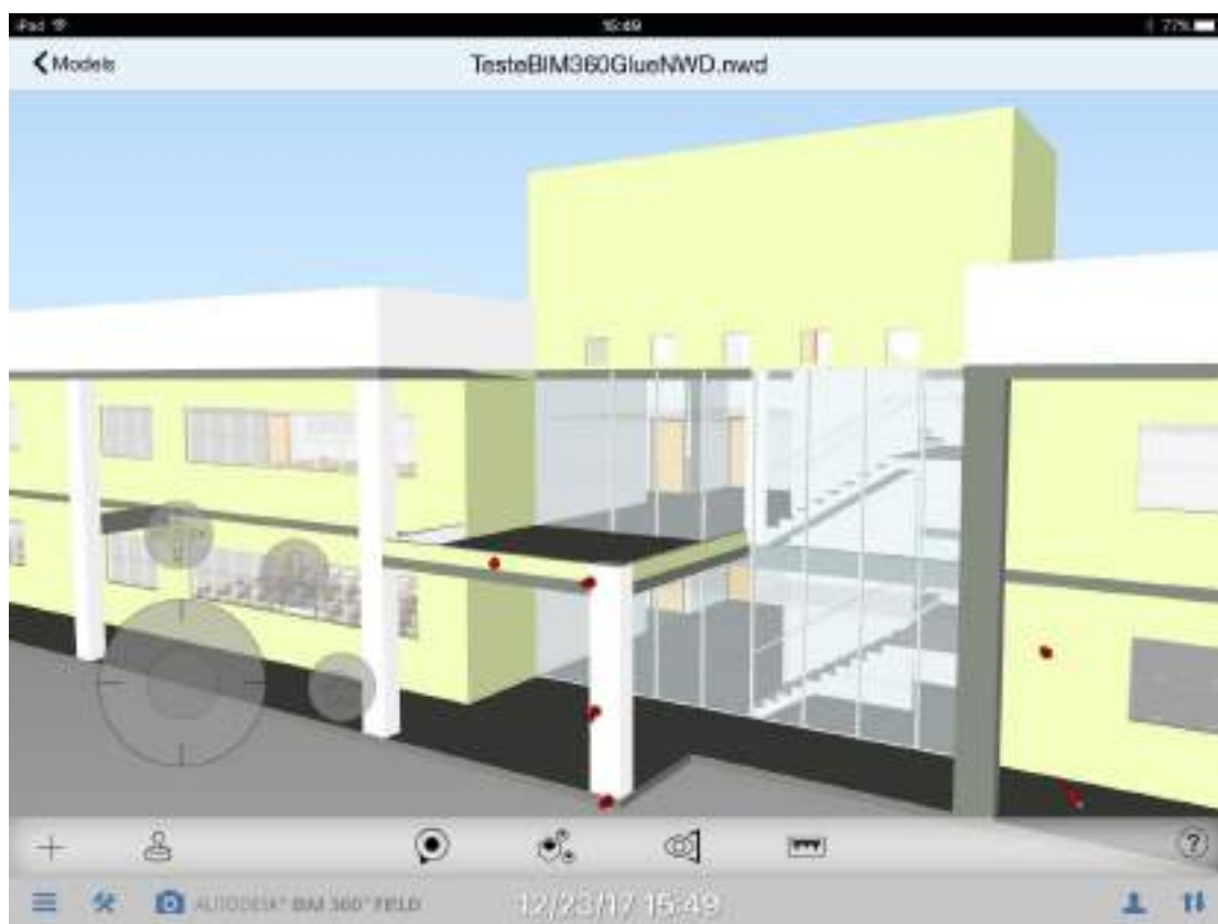
Figura 9. Visualização de pins em objetos localizados na fachada do CT-12
