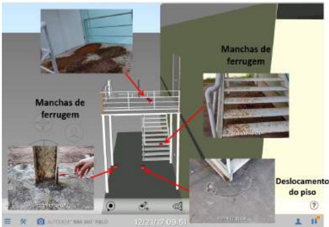
Figura 12. Exemplos de associação de pins com fotografias dos danos na lateral esquerda do CT-12.
